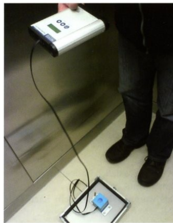
Körperschallmessung auf dem Kabinenboden
