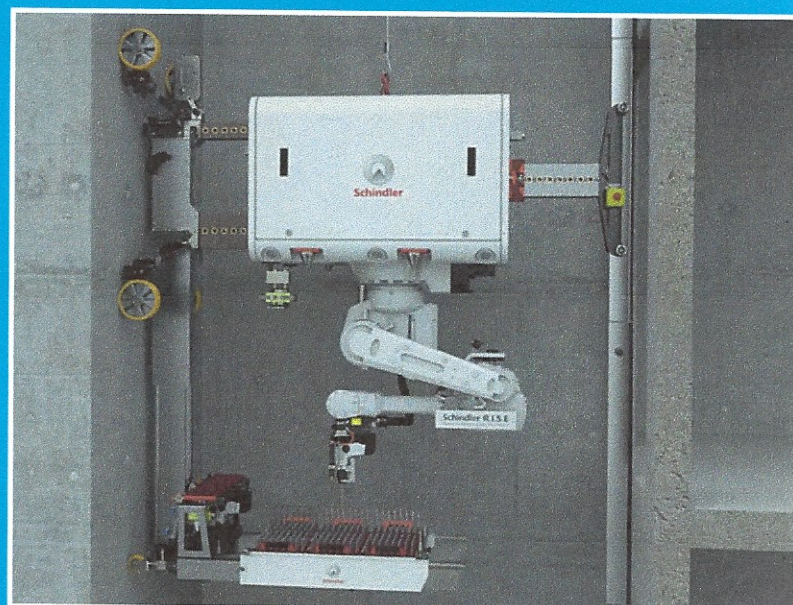
Bild 2: 3D-Grafik des Installationsroboters R.I.S.E.
