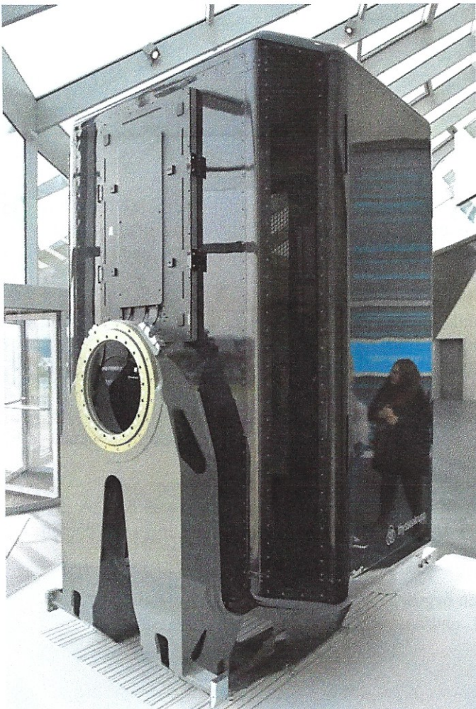
Eine Kabine für den MULTI ausgestellt im Testturm.
